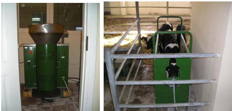
Рисунок 29 – Установка автоматизированная для поения телят УАВТ-60
