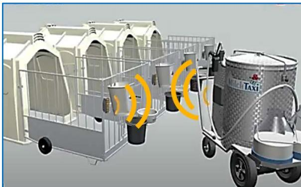
Рисунок 26 – Схема работы «молочного такси» оснащенного автоматической системой индивидуального дозирования.
